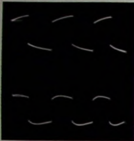
Bild 40. Andere Oszillogrammformen bei nicht gut eingestellter Kompensation eines Abschwächers
