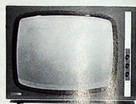
Beim neuen 47-cm-Fernsehempfänger „Ines 5151“ ist der Kanalwähler rechts seitlich herausgeführt (VEB Fernsehgerätekwerke Staßfurt)
