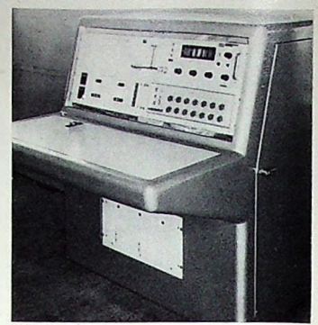
Bild 4. Automatische Prüfanlage von Marconi mit Blocklesetechnik für die Prüfung einer Anzahl von Parametern in einem Mikrominiatur-Baustein
